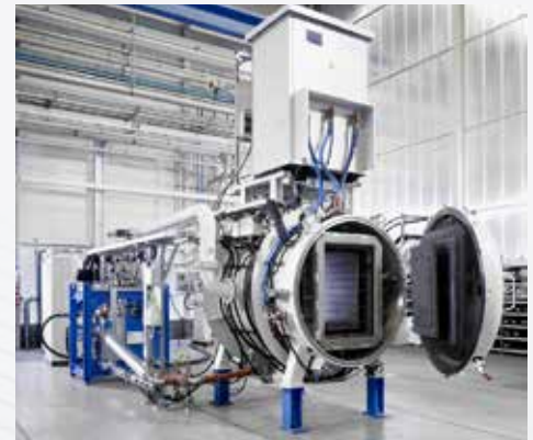
Forno de tratamento térmico COV
